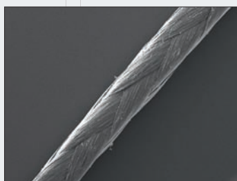
Hulk Line unter dem Rasterelektronenmikroskop.
